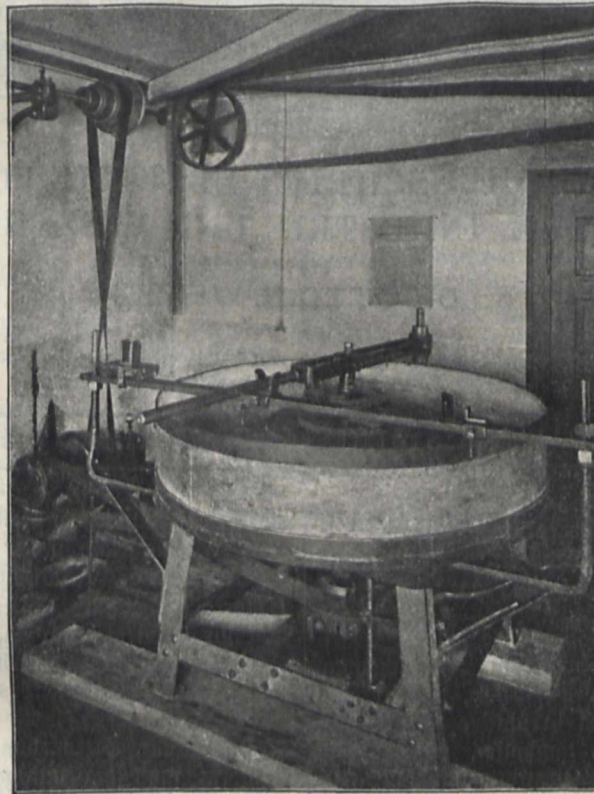
Die Herstellung grosser Teleskop-Linsen: Maschine für den Grobschleif- und Rohpolitur-Process.
