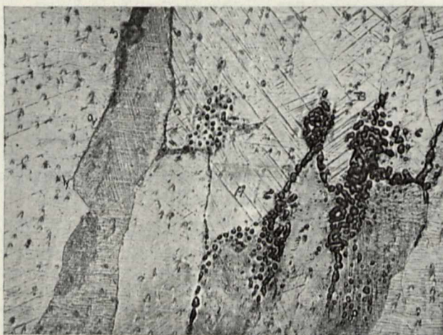
Rys. 7. Pow. 100 \times \emptyset . Szereg krystalitów, jak np. A, B i C, oddzielonych od sąsiadów szparami i pustkami. Szpara 1—2 wyraźnie rozszerza się w kierunku 2—3. Szpara 4—5 przechodzi w dużą pustkę.
