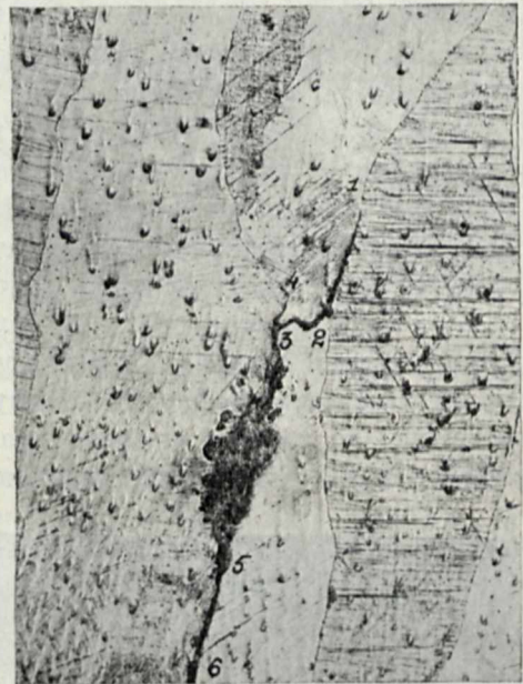
Rys. 6. Pow. 100 \times \emptyset . Widoczna jest szczelina międzykrystalitowa 1—2—3—4 i pustka 3—5, przechodząca w szczelinę 5—6.
