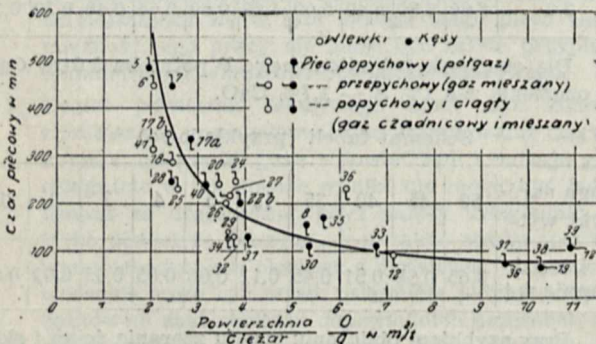
Rys. 1. Zależność czasu piecowego w od stosunku \frac{O}{g} .
