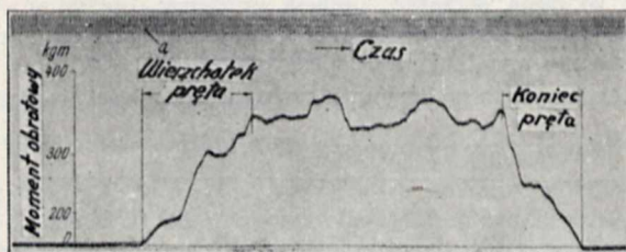
Rys. 4. Przebieg siły obrotowej przy walcowaniu taśm 50 \times 4 \text{ mm}^2 z żelaza St 37 (a = napięcie zmienne 50 Hz).
