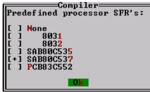
Rys. 3.9. Okno wyboru typu mikrokontrolera.
