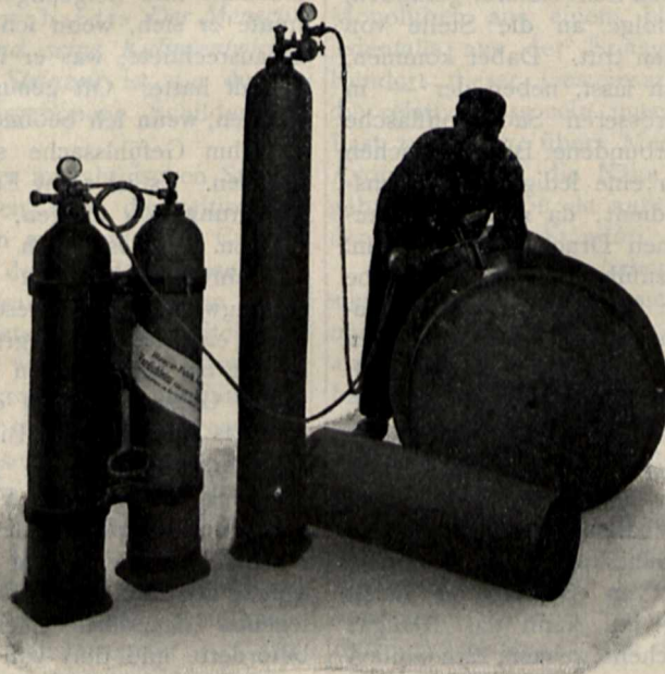
Blaugas-Schweissapparat. Aufschweissen eines Kesselringes.
