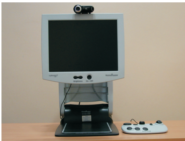
Fot. 3. Powiększalnik myReader2 z pulpitem sterowniczym oraz kamerą
