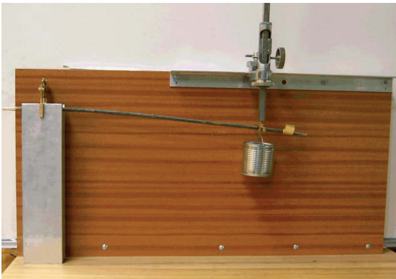
Fot. 4.3. Stanowisko badawcze do pomiaru modułu sprężystości Phot. 4.3. Research stand for measuring the modulus of elasticity
