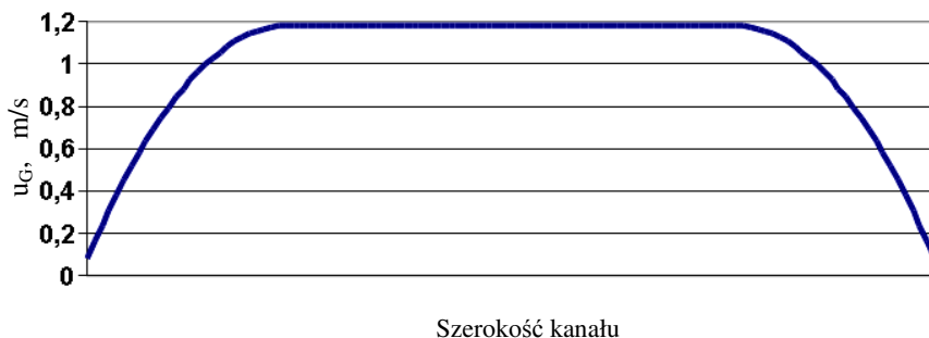
Rys. VI.2. Przykład profilu prędkości wlotowej
