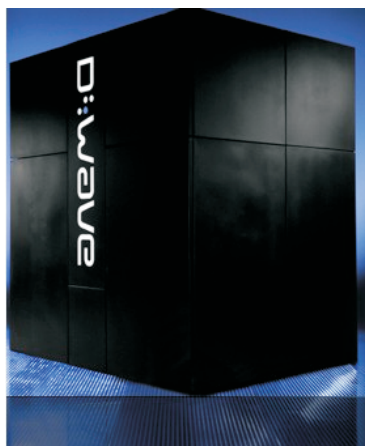
Rys. A.2. 128-qubitowy komputer kwantowy D-Wave-One.
