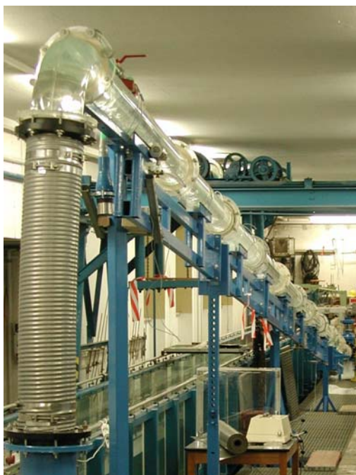
Rys. 12. Model przewodu ciśnieniowego o swobodnym spadku w Laboratorium Huberta–Engela Fig. 12. Model of pressure pipeline with free slope in the Hubert–Engel Laboratory
