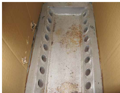
Wylot ogrzanego powietrza z części grzewczej nagrzewnicy Outlet of hot air from the heating part of heater
