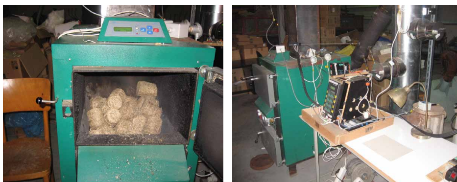
Fot. 2. Zdjęcia przedstawiające komorę spalania nagrzewnicy VIGAS oraz oprzyrządowanie stanowiska pomiarowego Phot. 2. View of combustion chamber of VIGAS heater and equipment of the measurement stand
