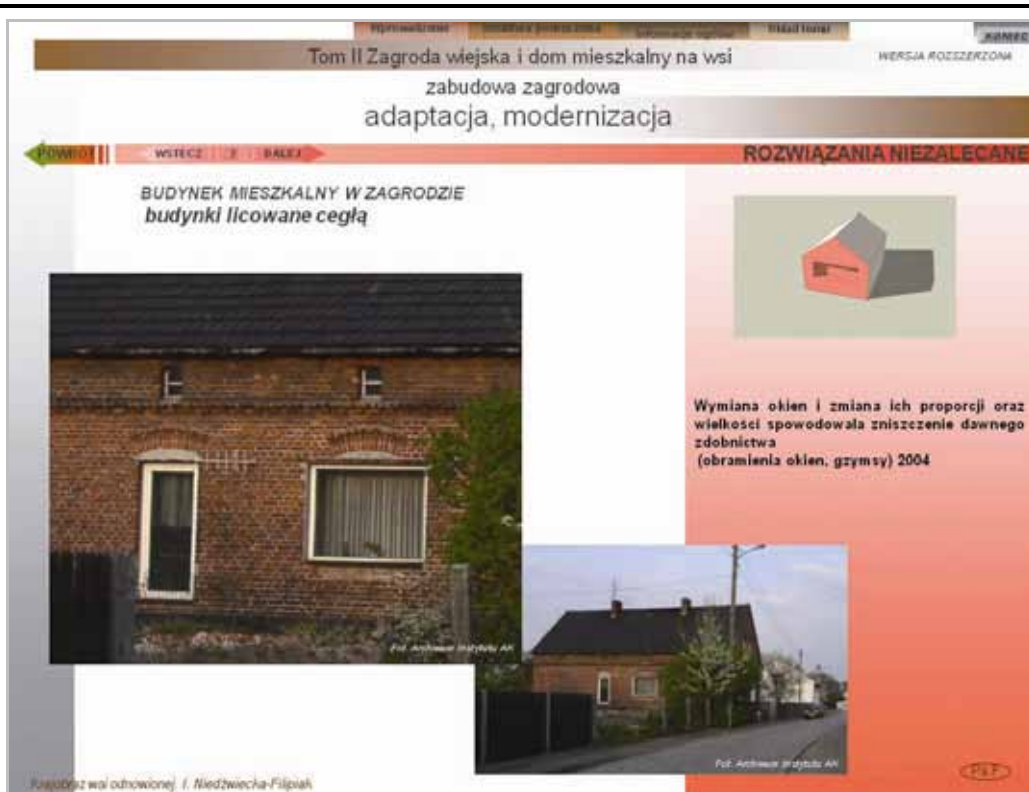
Ryc. V.7. Przykładowe rozwiązanie niezalecane w zakresie adaptacji i modernizacji zabudowy zagrodowej Draw. V.7. Exemplary, not recommended solution in the range of adaptation and modernization of a farm building
