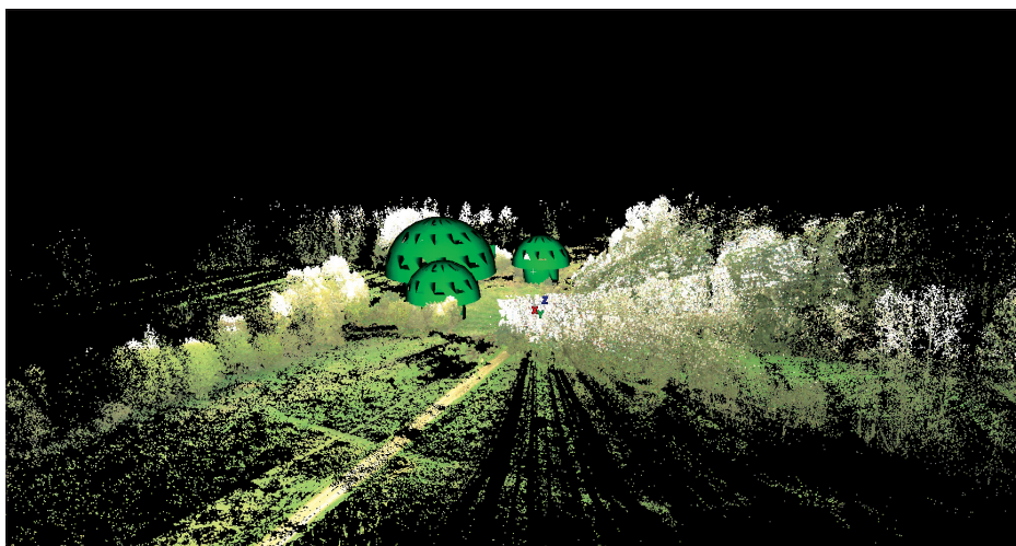
Rys. 22. Widok terenu prowadzonych pomiarów za pomocą skanera Leica ScanStation – chmura punktów w programie do przetworzenia wraz z bryłą oczyszczalni ścieków
