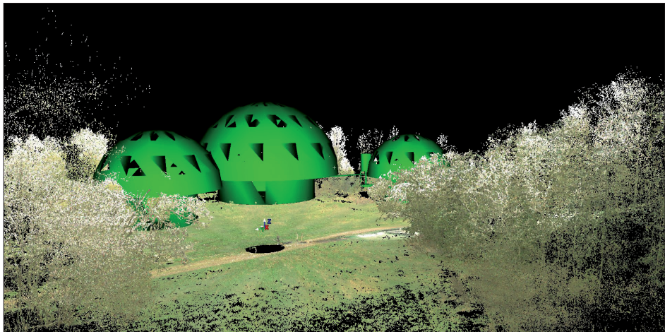
Rys. 21. Widok terenu prowadzonych pomiarów za pomocą skanera Leica ScanStation – chmura punktów w programie do przetworzenia wraz z bryłą oczyszczalni ścieków Fig. 21. View of the area of measurement with the use of Leica ScanStation scanner – a cloud of points in the program for transformation with the building of sewage treatment plant
