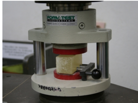
Rys. 4.39. Badanie wytrzymałości kleju na ściskanie wg [194]
