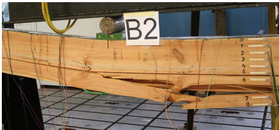
Rys. 4.58. Postać zniszczenia belki B2
