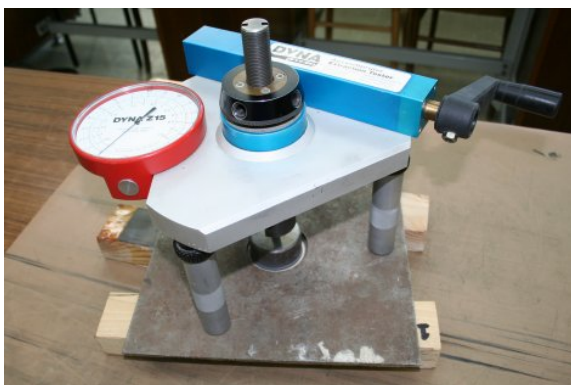
Rys. 4.41. Umieszczenie próbki w przyrządzie DYNA Z15 do wyznaczania wytrzymałości połączenia „drewno - klej - drewno” na odrywanie
