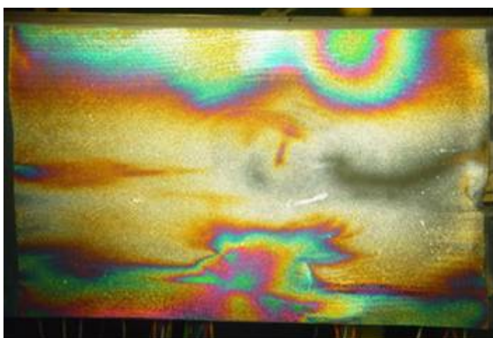
Rys. 4.192. Obraz izochrom całkowitych - belka F2 ( F = 25 \text{ kN} )
