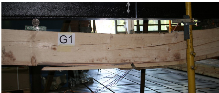
Rys. 4.142. Postać zniszczenia belki G1
