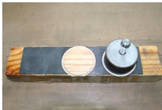
Rys. 4.42. Próbką z naklejonym oraz oderwanym krążkiem do badania wytrzymałości połączenia „drewno - klej - drewno” na odrywanie
