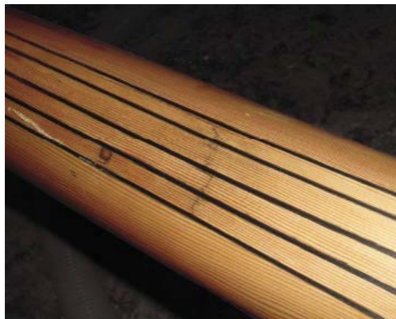
Rys. 3.36. Maszt po wklejeniu taśm CFRP, [8]
