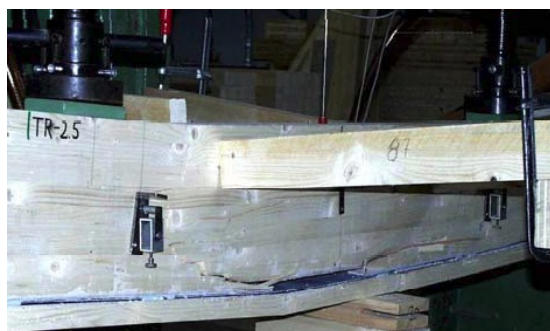
Rys. 3.19. Postać zniszczenia belki z wklejonym zbrojeniem CFRP pod ostatnią lamelą, [18]
