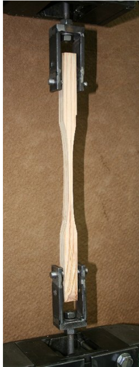
Rys. 4.27. Badanie wytrzymałości drewna na rozciąganie wzdłuż włókien
