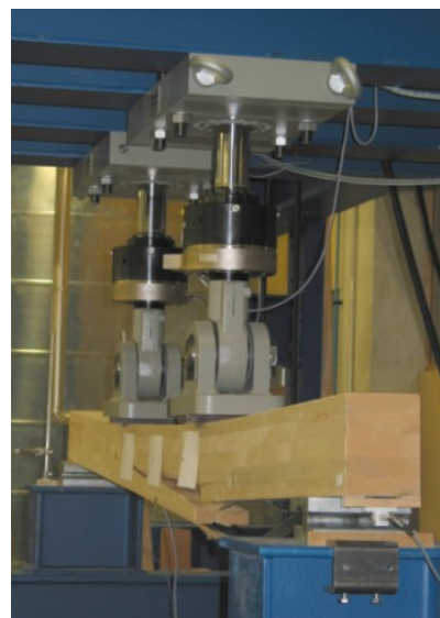
Rys. 3.24. Przykładowy obraz zniszczenia belki wzmocnionej sprężoną taśmą CFRP, [37]
