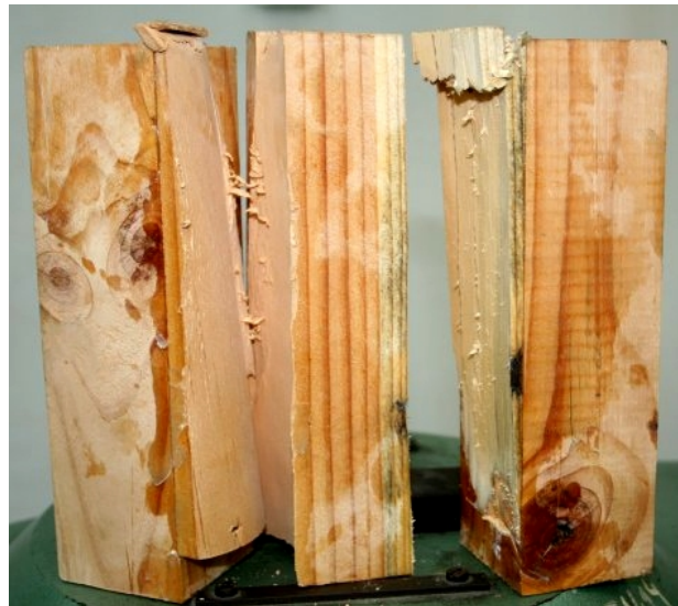
Rys. 4.44. Przykładowa próbka po zniszczeniu przy próbie badania wytrzymałości na ścinanie przy ściskaniu połączenia „drewno - klej - drewno”
