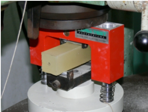
Rys. 4.38. Badanie wytrzymałości kleju na zginanie wg [194]
