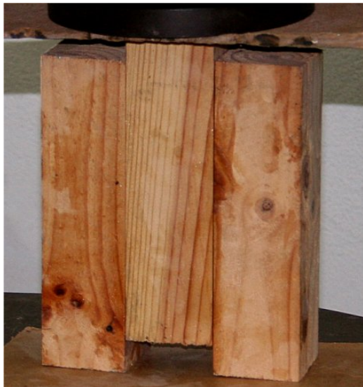
Rys. 4.43. Badanie wytrzymałości na ścinanie przy ściskaniu połączenia „drewno - klej - drewno”
