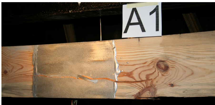
Rys. 4.49. Postać zniszczenia belki A1 (widoczna doklejona warstwa elastooptyczna)
