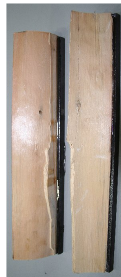
Rys. 4.34. Przykładowa próbka po zniszczeniu przy badaniu wytrzymałości na ścinanie wzdłuż włókien drewna, wg [197]
