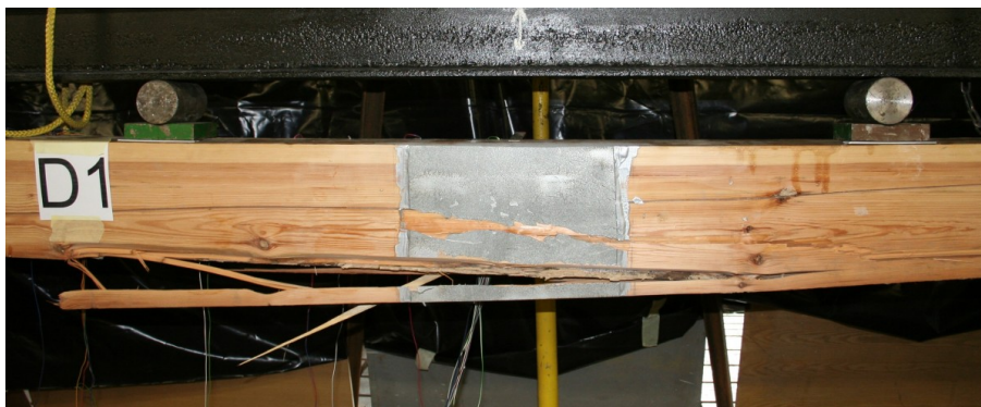
Rys. 4.88. Postać zniszczenia belki D1 (widoczna doklejona warstwa elastooptyczna)
