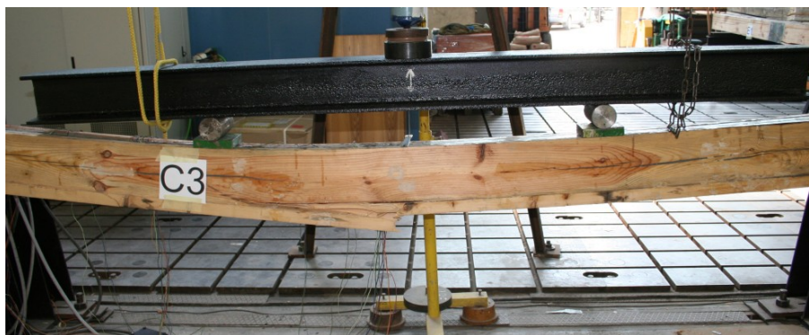
Rys. 4.73. Postać zniszczenia belki C3
