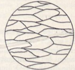
Durch Kaltrecken gestreckte Kristalle.
