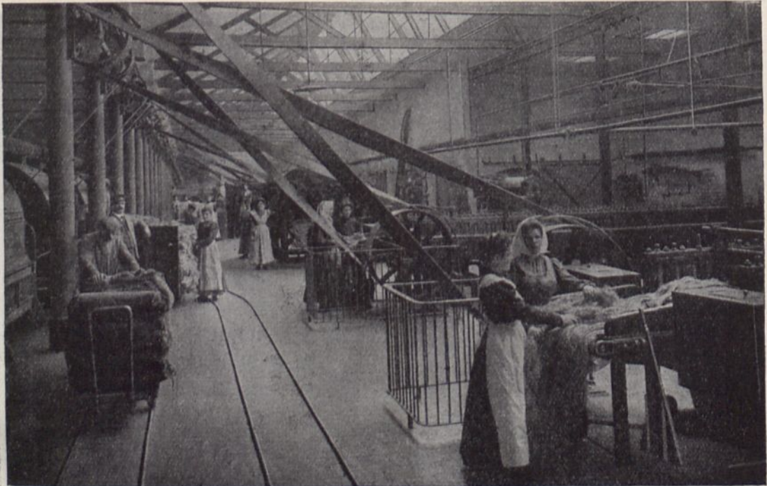
Batschmaschinen, auf denen die Jute mit Tran, Öl und Wasser eingeweicht und durch Quetschen geschmeidig gemacht wird. (Aus der Jubiläumsschrift der Jutespinnerei und Weberei Bremen.)
