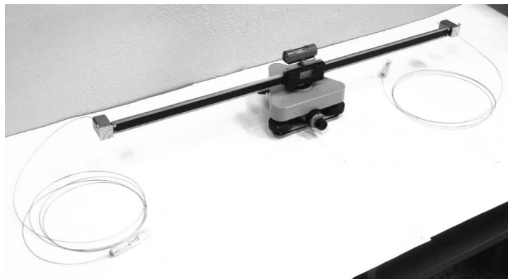
Rys. 5.33. Widok prototypu dwurefleksyjnego przyrządu do pomiaru kątowych i odległościowych na punktach przesłoniętych
