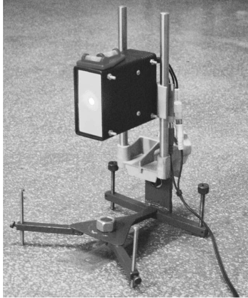
Rys. 5.94. Odbiornik kontrolny na punkcie odniesienia Fig. 5.94. Check receiver on reference check point
