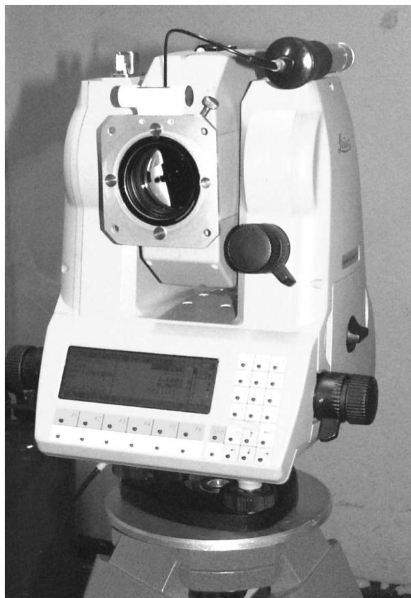
Rys. 5.55. Tachymetr TC1800 z prototypem światłowodowej tarczy autorefleksyjnej Fig. 5.55. TC1800 tachymeter with prototype of optical fibre auto-reflective fixed target
