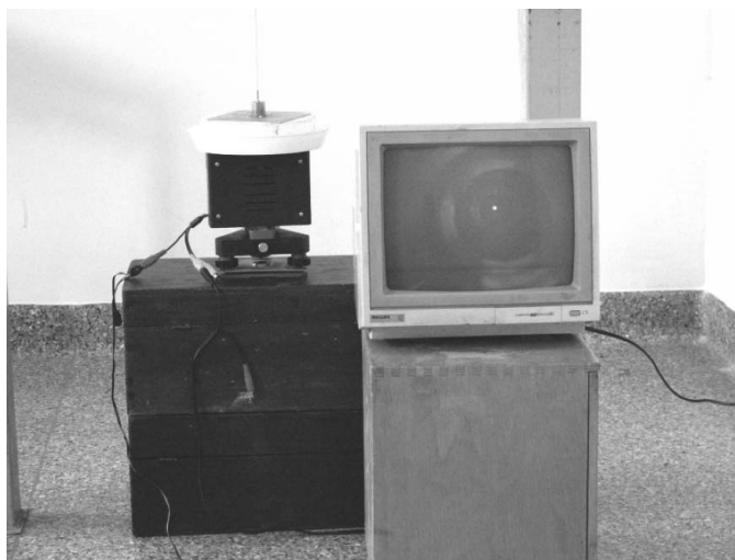
Rys. 5.64. Zespół fotodetekcyjny pionu światłowodowego w trakcie pomiarów testujących Fig. 5.64. Photo-detection unit of optical fibre plummet during testing
