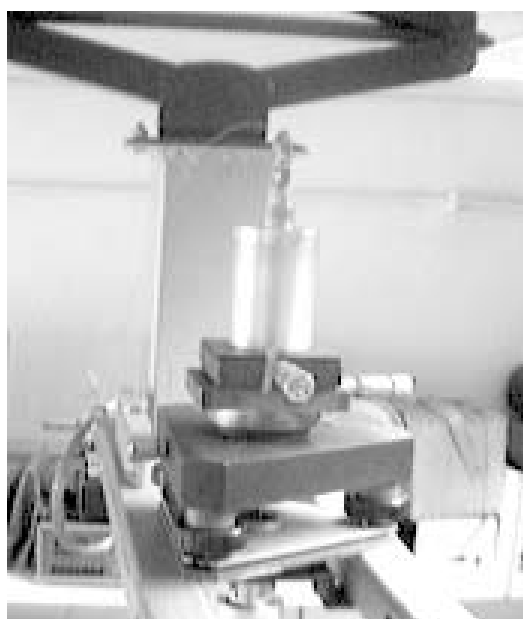
Rys. 5.153. Widok mikrometrycznego symulatora przesunięć w położeniu roboczym Fig. 5.153. View of micrometric displacement simulator in working position
