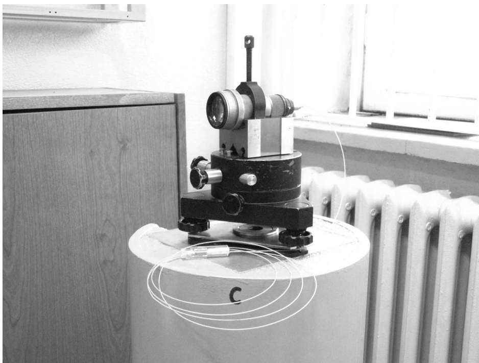
Rys. 5.31. Widok prototypu lunety jednotubusowej na słupie obserwacyjnym Fig. 5.31. Prototype view of single tube telescope on observational pillar
