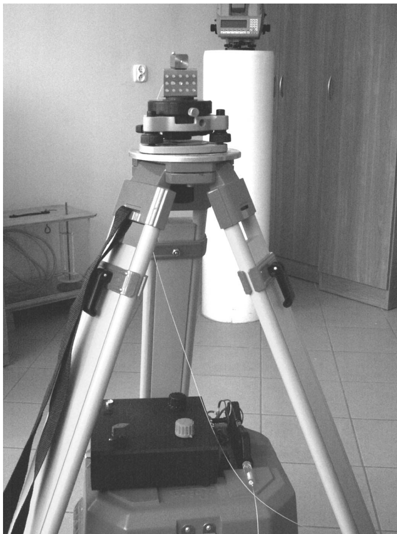
Rys. 5.23. Punktowy światłowodowy sygnalizator z modulatorem światła (prototyp umieszczony pod i nad głowicą statywu) Fig. 5.23. Optical fiber point indicator with light's modulator (prototype placed below and up head of tripod)
