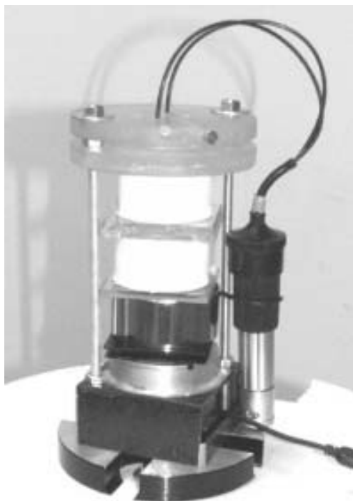
Rys. 5.48. Prototyp libelli optoelektronicznej typu liniowego Fig. 5.48. The prototype of optical-electronic level in liquid version
