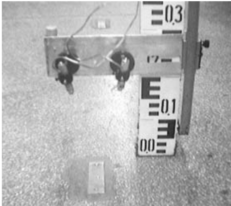
Rys. 5.110. Laserowa Stopka Sygnalizacyjna (prototyp) Fig. 5.110. Laser Indicating footer (prototype)
