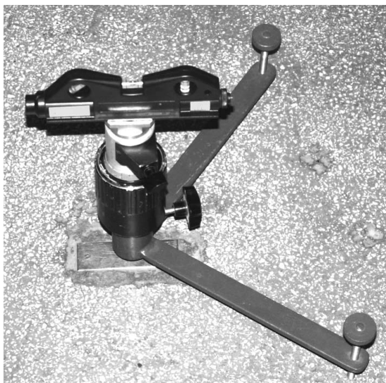
Rys. 5.92. Nadajnik na punkcie odniesienia bazy testowej Fig. 5.92. Transmitter on test base reference point
