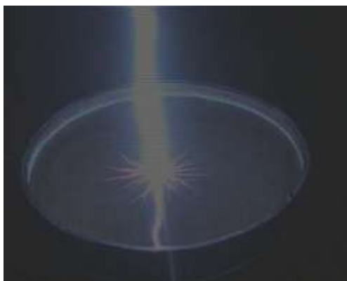
Rys. 3. Wyładowanie z generatora Marxa (udar piorunowy normalny) do zbiornika wypełnionego wodą wodociągową.
