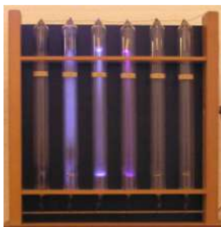
Rys. 9. Jonizacja gazu w trzech cylindrach pod napięciem AC 1100 V peak o częstotliwości 5 kHz.
