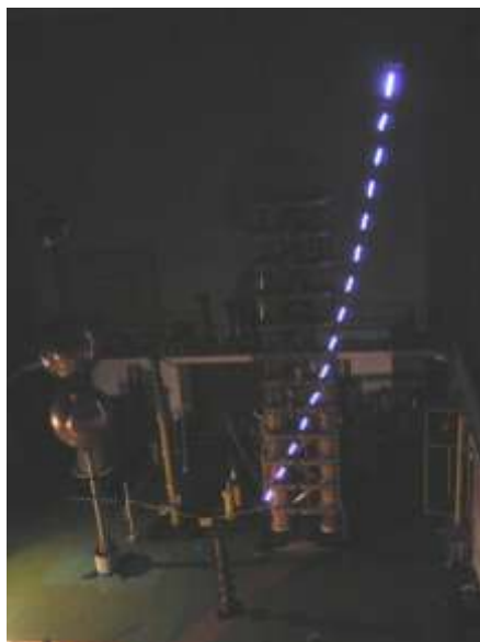
Fig. 11. Przebiecie iskierników w łańcuchu metalowych rurek
