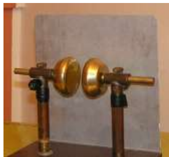
Rys. 2. Iskiernik płyta-płyta umieszczony blisko uziemionej płyty
