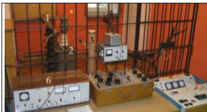
Rys. 1. Układ probierczy z mostkiem Scheringa i miernikiem wyładowań niezupełnych
