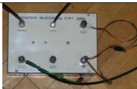
Rys. 5. Impedancja pomiarowa ZUW-1
