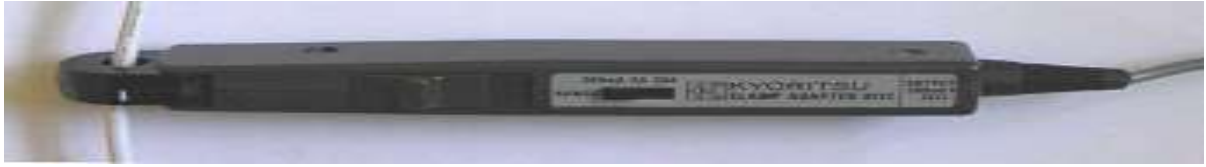
Rys. 4. Sonda prądowa KYROYTSU model 8112, zakresy prądowe 200 mA/ 2 A/ 20 A, 40 Hz – 10 kHz, w zakresie do 200 mA, stała pomiarowa wynosi 1 mA/mV
