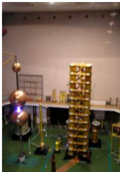
Fig. 12. Zapłon iskiernika kulowego
