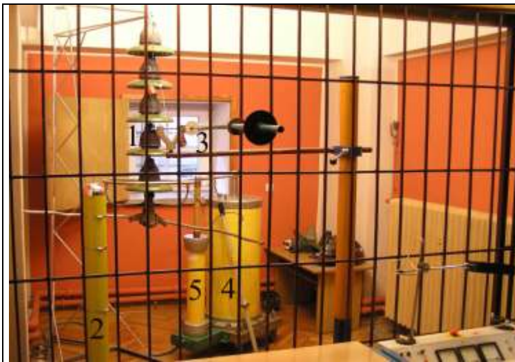
Rys. 1. Stanowisko z łańcuchem izolatorów kołpakowych i modelem izolatora wsporczeo
