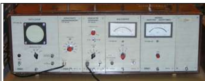
Rys. 4. Miernik wyładowań niezupełnych MWN
