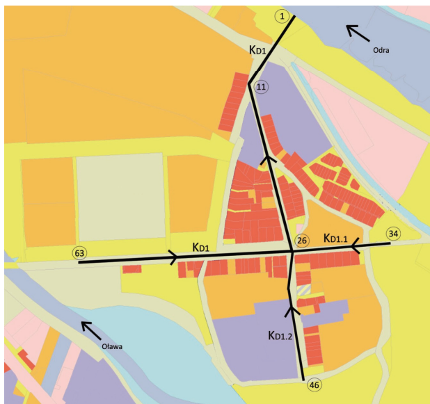
Rys. 6.2. Kanalizacja deszczowa osiedla Rakowiec
