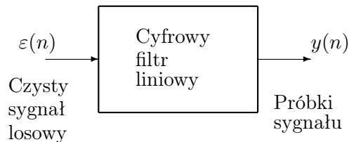
Rys. 13.1. Model Yule'a generacji sygnału losowego y(n) z szumu białego \varepsilon(n) .
