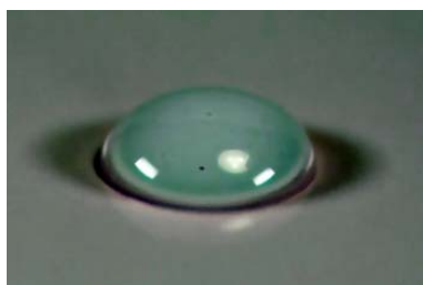
Rys. 6.20. Przykład powierzchni minimalnej synklasycznej – kropla wody
