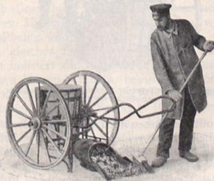
Aufkehren des Kehrichts auf die mit dem Apparat verbundene Schaufel.
