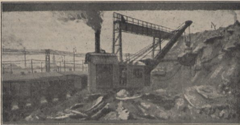
Löffelbagger von Menck & Hambroek G. m. b. H. in Altona zum Verladen von geschüttetem Massengut.
