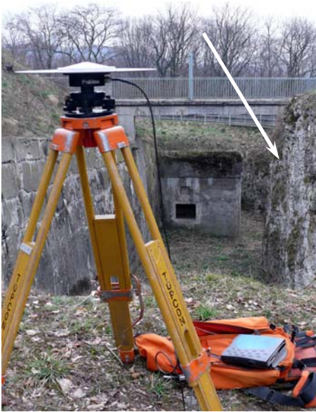
Rys. 10. Wyznaczanie współrzędnych punktu G_KAP za pomocą techniki GPS i pomiarów kąto-liniowych
