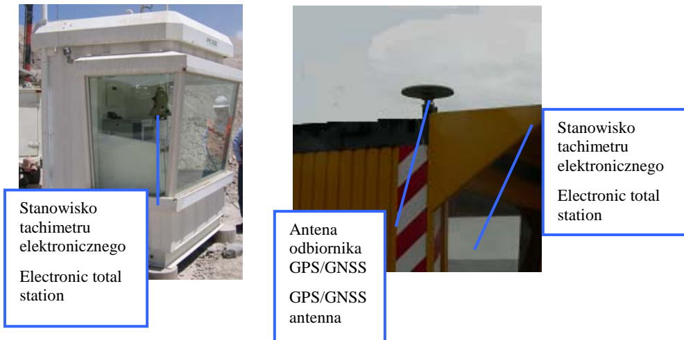
Rys. 6. Widok przykładowego kontenera stacji tachymetrycznej w zadaniach zintegrowanego monitoringu obiektów inżynierskich (źródło: Leica Geosystems)
