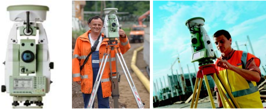
Rys. 1. Widok zintegrowanej stacji pomiarowej SmartStation stanowiącej połączenie odbiornika GPS z precyzyjnym tachimetrem elektronicznym oraz przykłady jej użycia (źródło: Leica Geosystems)
