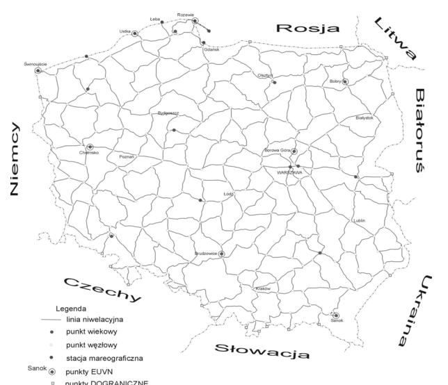
Rys. 8. Sieć niwelacji precyzyjnej I klasy pomierzonej w latach 1997–2003 Fig. 8. First class levelling campaign 1997–2003
