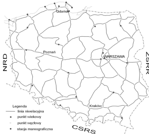
Rys. 5. Sieć niwelacji precyzyjnej I klasy pomierzonej w latach 1974–1979 [Wyrzykowski 1993]
