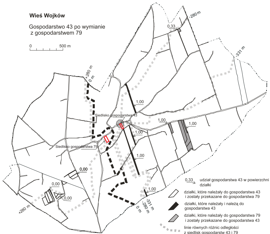
Ryc. 2. Działki gospodarstwa 43 po wymianie z gospodarstwem 79 pozwalającej na zbliżenie gruntów do siedlisk w obu gospodarstwach przeciętnie o około 150 m
