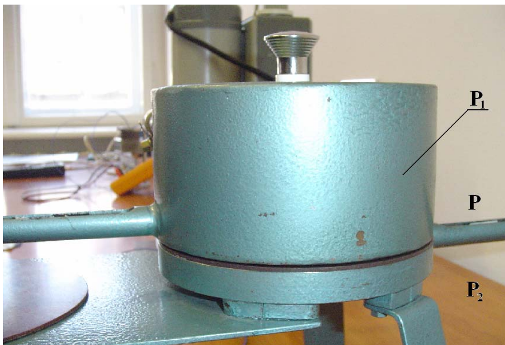
Rys. 12.3 Układ płyt do pomiaru przewodności cieplnej izolatorów
