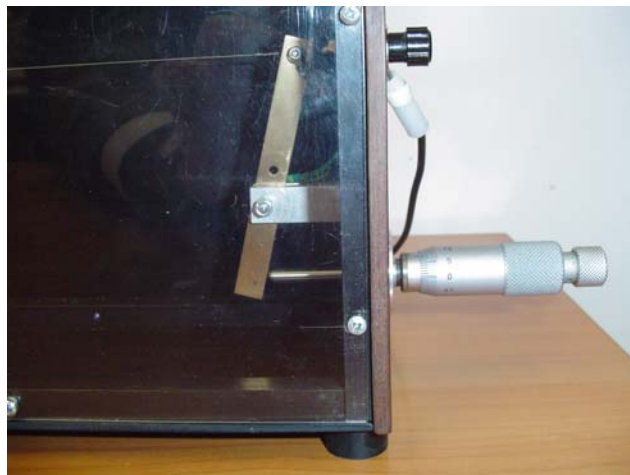
Rys.13.6 Sposób pomiaru wydłużenia drutu po ustaleniu się równowagi termodynamicznej
