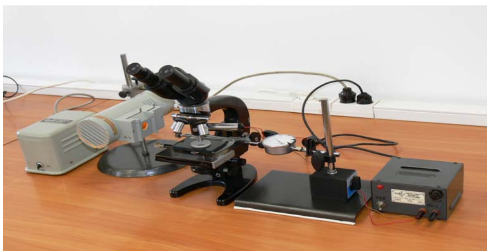
Rys. 38.11. Zestaw pomiarowy do wyznaczania promieni krzywizny soczewek.
