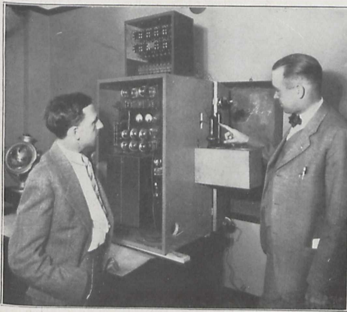
Fig. 5. R. J. Wensley (rechts) an seinem Televox-Apparat, der nur durch bestimmte Töne betätigt wird, und an Stelle eines Dienstboten Aufträge ausführen kann. Phot. Internat. Press Büro
