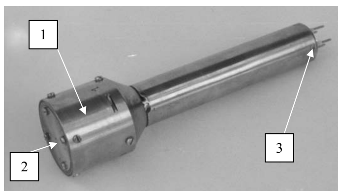
Rys. 6.8. Analizator pola opóźniającego RFA1, używany również jako sonda SPN3 i SPO2 (tab. 5.2, rys. 5.2); 1 – głowica analizatora, 2 – przysłona z otworem wlotowym, 3 – wyjście z zaciskami przyłączeniowymi
