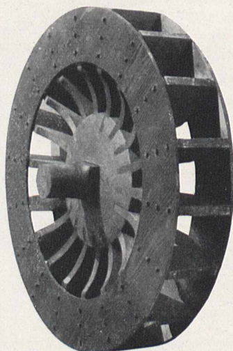
Bild 2. Nach den Hohlräumen des Steines wurde das antike Wasserrad in Holz nachgebildet.
