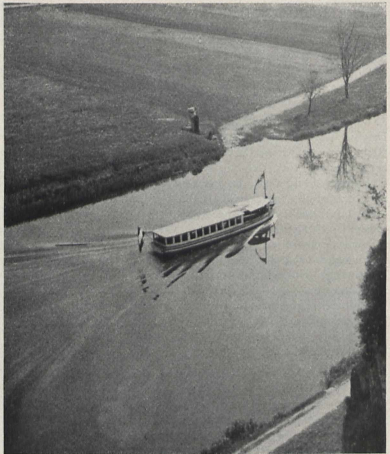
Bild 1. Schon dieses kleine Boot erzeugt gut sichtbare Bugwellen. Bei größeren Schiffen und Schleppzügen werden diese so stark, daß bei ständigem Verkehr die Uferböschungen angegriffen werden
