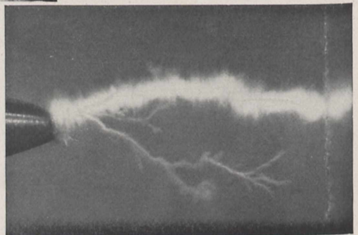
Bild 6. Vorentladung zwischen negativer Spitze und positiver Platte
