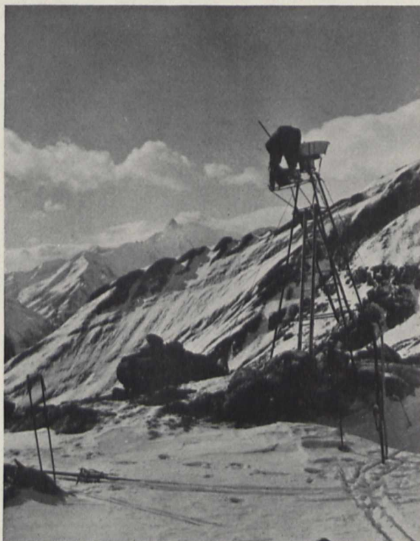
Bild 6. Ein Gebirgsniederschlagsmesser, der den gesamten Niederschlag eines längeren Zeitraums in flüssiger Form (Salzzusatz!) sammelt, wird abgelesen
