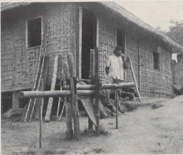
Bild 6. Zuckerrohrpresse mit Handbetrieb in der Serra do Mar
