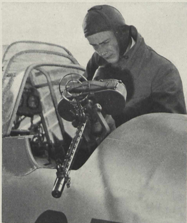
Bild 6. Das Beobachter-MG im neuzeitlichen Mehrzweckflugzeug „Ar 95“ auf Arado-Schwenkarmlafette. Die Waffe läßt sich bequem von der einen zur anderen Bordwand über jede beliebige Zwischenstellung schwenken
