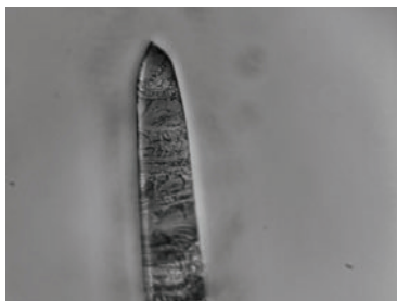
Rys. 8.3. Obraz zarejestrowany za pomocą mikroskopu z kontrastem fazowym. Przekrój poprzeczny soczewki kontaktowej; widać wyraźnie niejednorodności materiału (zdjęcia autorstwa I. Buzalewicz z badań prowadzonych w Grupie Bio-Optyki)
