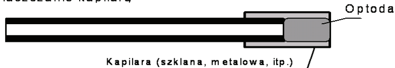
Rys. 11.7. Sposoby łączenia optod ze światłowodami
