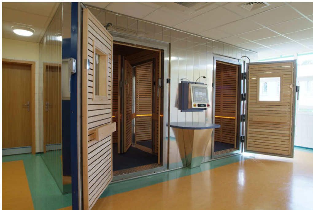
Rys. 1. Kriokomora firmy CREATOR w budynku P-4 Akademii Wychowania Fizycznego we Wrocławiu
