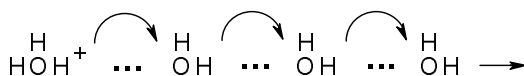
Rysunek 1. Schemat mechanizmu Grotthussa w postaci sprzężonych aktów elementarnych transferu pojedynczego protonu pomiędzy cząsteczkami wody [7]
