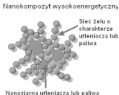
Rysunek 17. Schemat struktury wysokoenergetycznego materiału otrzymanego metodą zol-żel [5]
