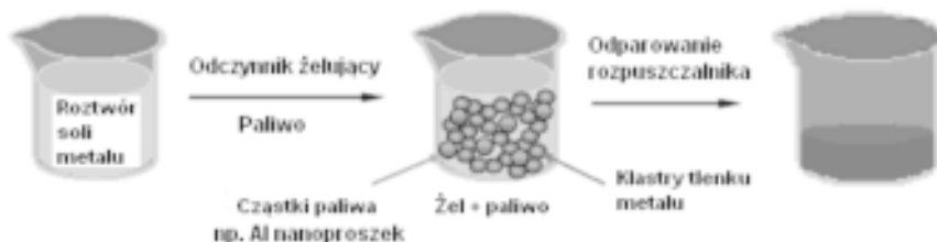
Rysunek 18. Schemat otrzymywania kompozytów utleniacz-paliwo metodą zol-żel
