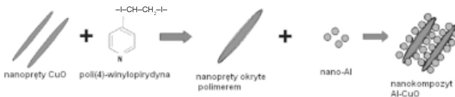
Rysunek 12. Schemat otrzymywania nanokompozytu Al/CuO w procesie wykorzystującym samoorganizację cząstek składników [27]
