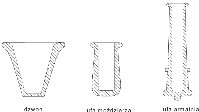
Rysunek 1. Ilustracja podobieństwa kształtów dzwonu i luf wykonywanych techniką odlewania ze spiżu w glinianych formach
