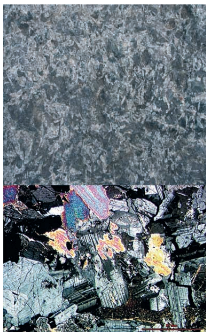
Ryc. 7. Gabro: makro- i mikrofotografia (makro – u góry, mikro – u dołu)
