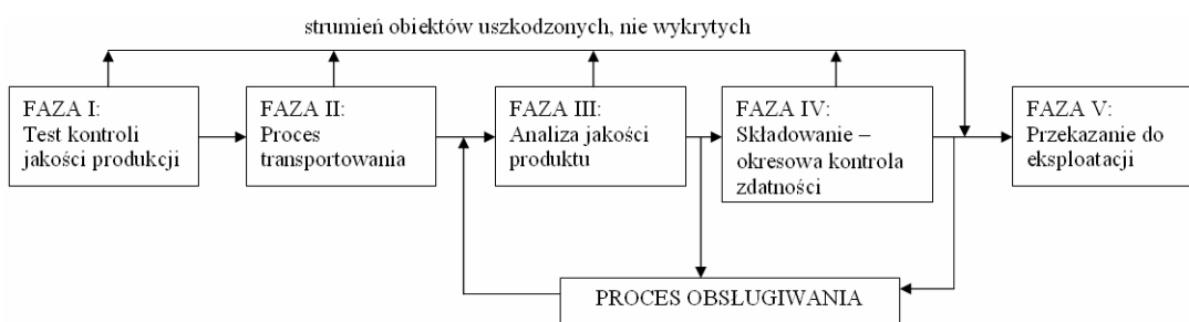
Rys. 2.1.11. Model niezawodności elementów składowanych z uwzględnieniem operacji kontroli stanu systemu [152]
