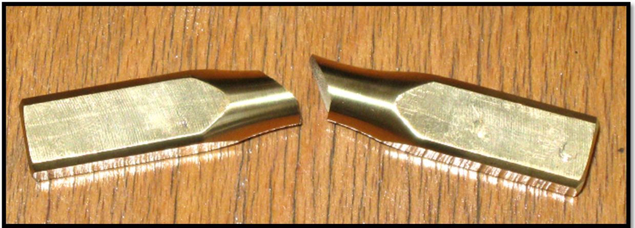
Rys. 29. Próbką wykonana z mosiądzu CuZn40Pb2
