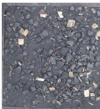
Rys. 30. Przesyp z użyciem 10 elementów mieszających (numer segmentu kasety odbierającej)
