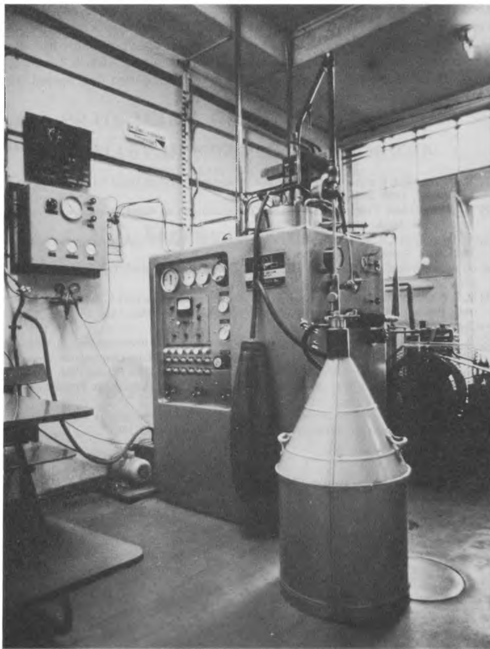
Fot. 3. Skraplarka helu firmy Little w Pracowni Niskich Temperatur Instytutu Fizyki PAN. Przy jej użyciu dokonano pierwszego w Polsce skroplenia helu w kwietniu 1960 r.
