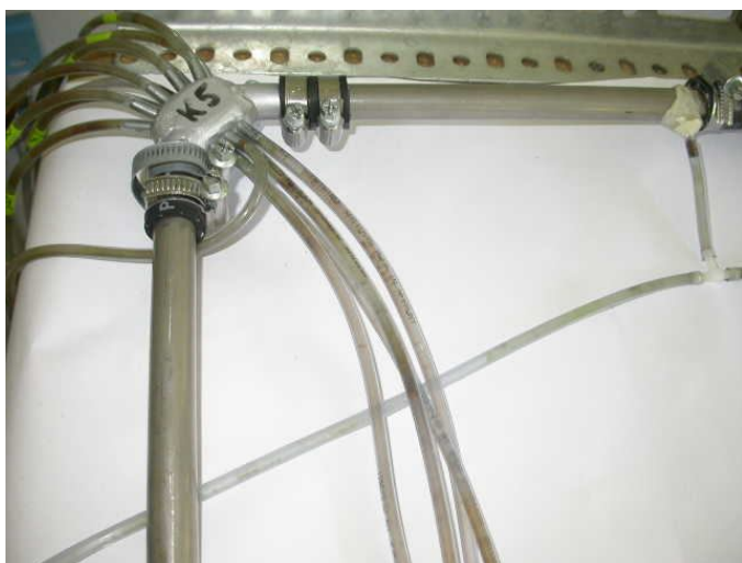
Rys. 3.6.4. Widok układu kolana przepływomierza K5 z otworami piezometrycznymi
