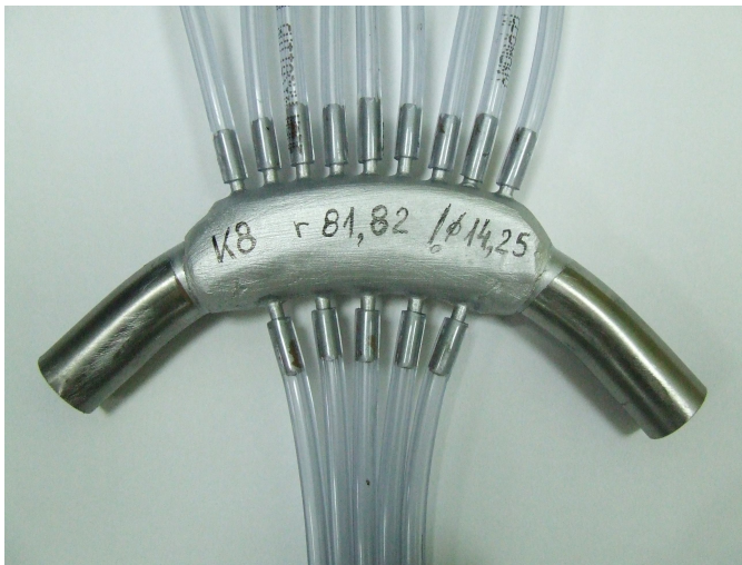
Rys. 3.3.5. Kompletnie kolano do pomiaru rozkładu spiętrzenia ciśnienia
