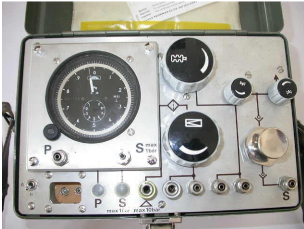
Rys. 3.1.7. Pneumatyczny zadajnik ciśnienia – tzw. walizka pomiarowa
