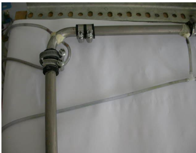
Rys. 3.6.3. Widok układu kolana przepływomierza K5 z dwoma otworami piezometrycznymi
