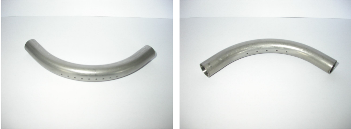
Rys. 3.3.4. Kolano K8 z wywierconymi otworami poboru ciśnienia na łuku zewnętrznym i wewnętrznym
