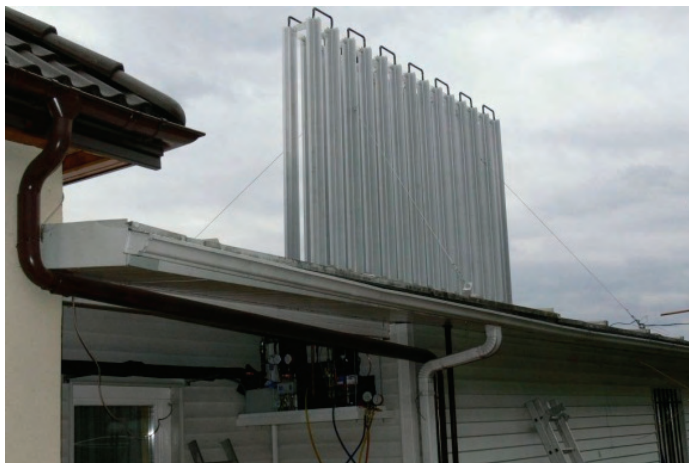
Rys. 4. Prototyp pompy ciepła z parowaczem o konstrukcji podobnej do przemysłowych wymienników do odgazowywania skroplonych gazów, fot. S. Reszewski
