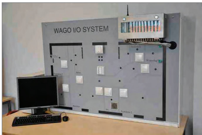
Rys. 7. Widok ogólny modelu instalacji systemu WAGO-I/O-System, fot. M. Kobusiński
