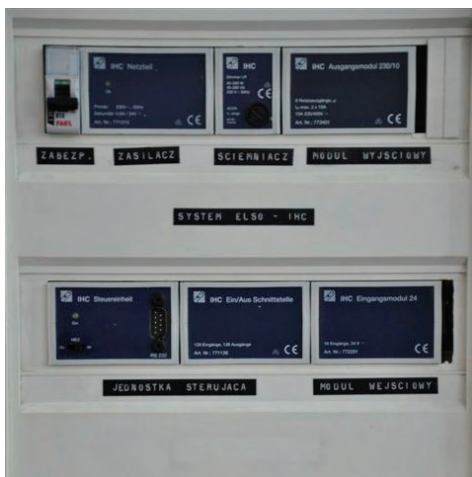
Rys. 1. Stanowisko laboratoryjne do badania instalacji systemu IHC:
