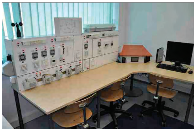
Rys. 5. Widok ogólny jednego z modeli instalacji w systemie KNX/EIB, fot. M. Kobusiński
