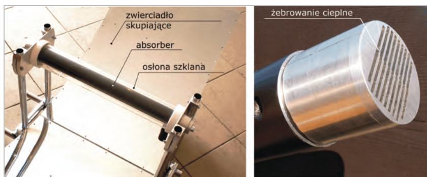
Rys. 3. Prototypowy kolektor słoneczny o budowie wewnętrznej dostosowanej do nagrzewania powietrza, oprac. J. Kasperski
