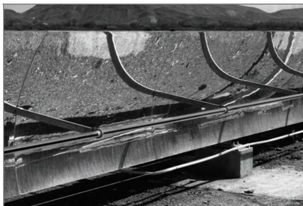
Rys. 1. Paraboliczny, rynnowy kolektor słoneczny w Plataforma Solar de Almeria, Hiszpania, fot. J. Kasperski
