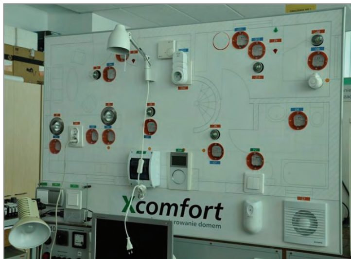
Rys. 3. Widok ogólny modelu instalacji przekaźnikowej systemu Xcomfort, fot. M. Kobusiński
