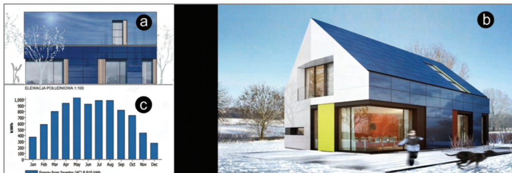
Rys. 9. Dom modelowy: a) elewacja, b) wizualizacja, c) wyniki symulacji energetycznej, oprac. własne
