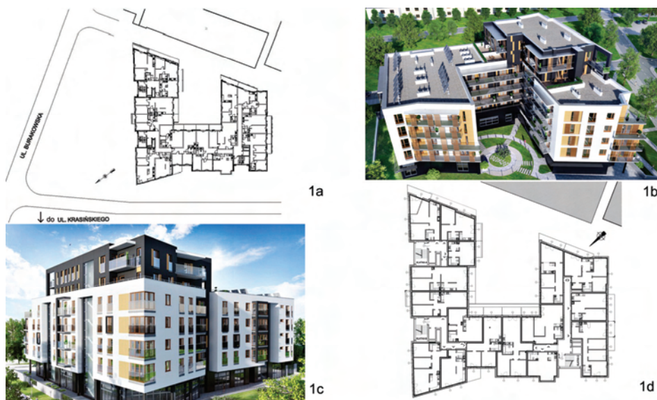
Rys. 1. Budynek mieszkalny: a) plan sytuacyjny, b) wizualizacja – widok od strony pd., c) wizualizacja – widok od strony pn., d) rzut typowej kondygnacji mieszkalnej [8]
