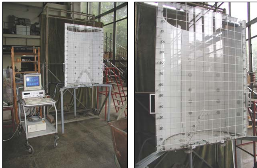
Rys. 5.5 Widok stanowiska pomiarowego do badań urządzeń odciążających
