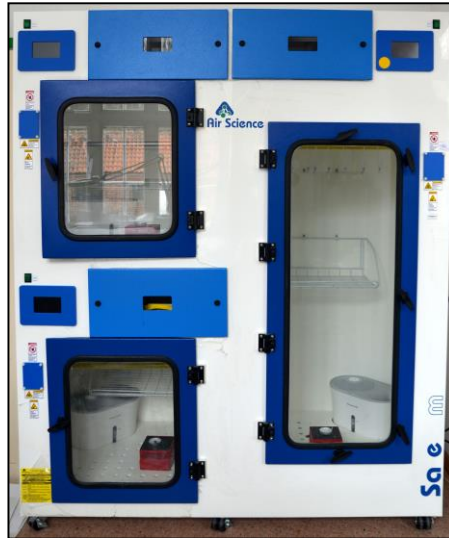
Rysunek 46. Komora cyanoakrylowa Model Safefume CATRI firmy Air Science z USA. Zbudowana z trzech oddzielnych komór z niezależnym systemem sterowania oraz bezkanałowym systemem filtrów węglowych
