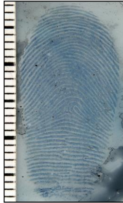
Rysunek 32. Odzworowanie linii papilarnych w kilkakrotnym powiększeniu ujawnione Sudan Black B, sfotografowane w świetle białym. Źródło – opracowanie własne
