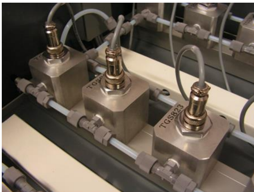
Rys. 7.4. Aluminiowe komórki pomiarowe w matrycy czujnikowej. Na zdjęciu widoczne połączenia komórek z systemem przewodów transportujących mieszaniny gazowe oraz przyłącza elektryczne czujników
