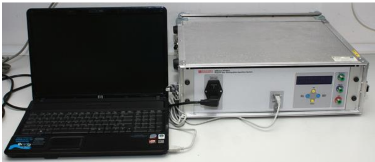
Rys. 10.3. Przenośny przyrząd pomiarowy działający na podstawie matrycy czujników wraz z przenośnym komputerem osobistym. Na zdjęciu widoczna jest płyta czołowa przyrządu umieszczonego w obudowie walizkowej (po prawej) oraz komputer typu laptop (po lewej), służący do konfigurowania systemu i odczytywania wyników pomiarów
