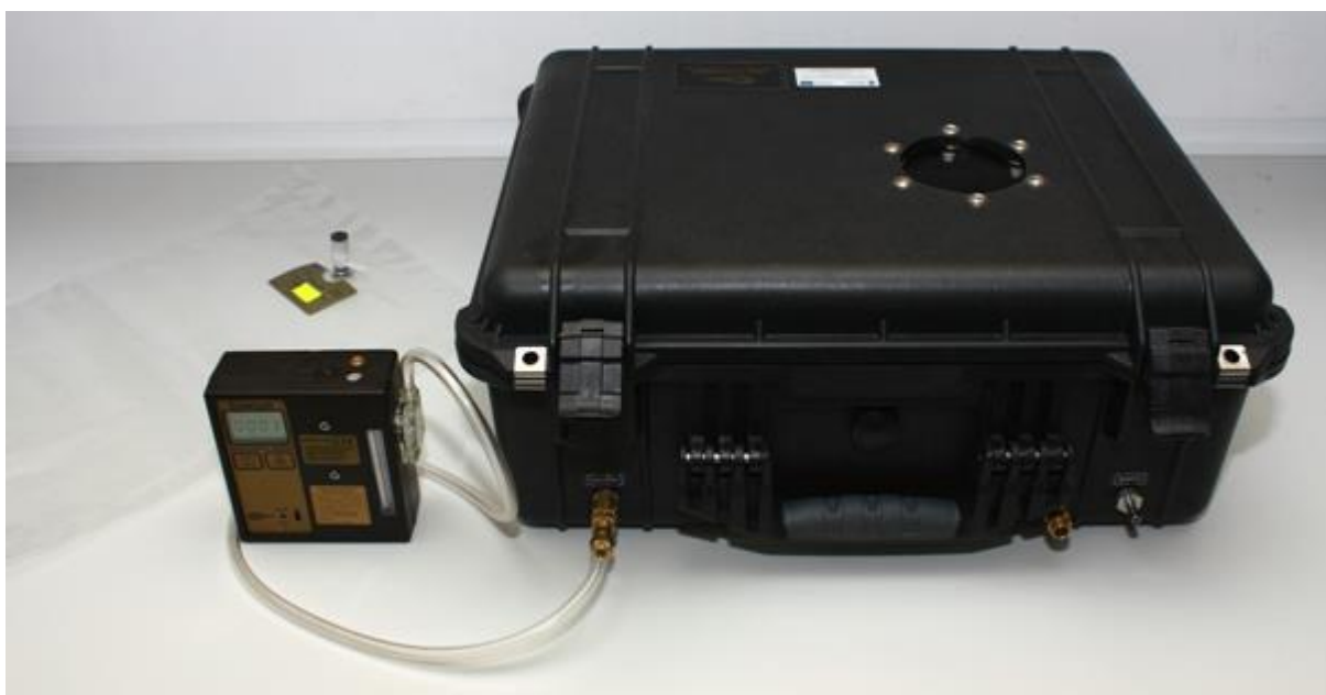
Rys. 10.1. Zestaw firmy SKC do pobierania próbek gazowych z wykorzystaniem „zasady płuca”. Na zdjęciu widoczny jest worek tedlarowy (po lewej), pompka membranowa (w środku) oraz sztywna walizka, w której wytwarzane jest podciśnienie (po prawej)
